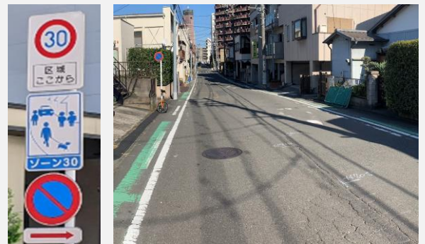
ゾーン30の標識/センターラインのない生活道路の例
